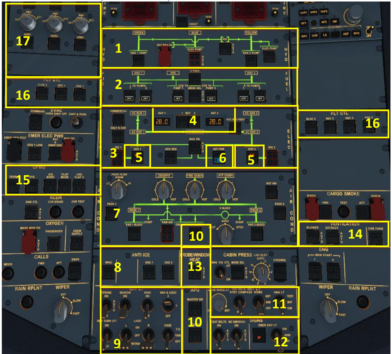
Picture 14: オーバーヘッド・パネル(F12)
