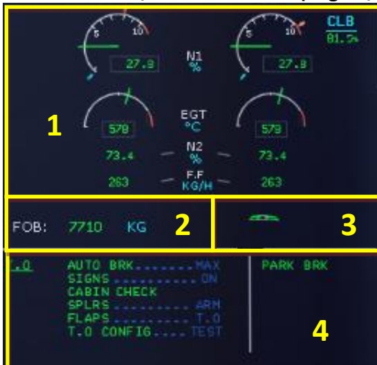
Picture 13: E/WD – エンジン/警告 表示装置 (Engine/Warning Display)
