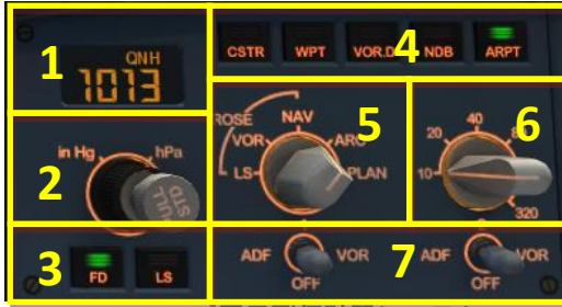
Picture 11: EFIS – 電子飛行計器システム (Electronic Flight Information System)
