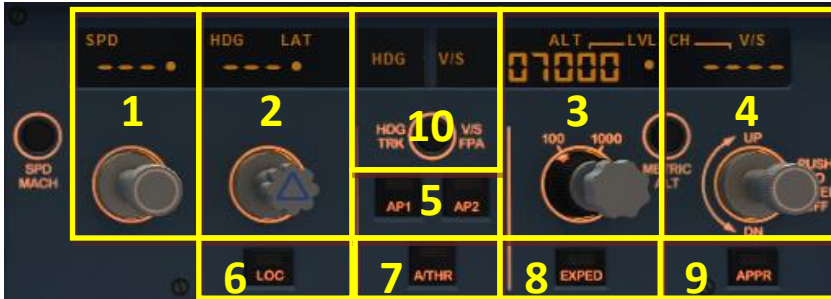
Picture 12: FCU – フライト・コントロール・ユニット (Flight Control Unit)
